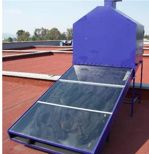
Prototipo de secador o deshidratador solar
