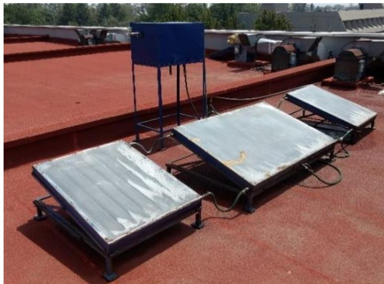
Prototipo de sistema de calentamiento solar de agua
