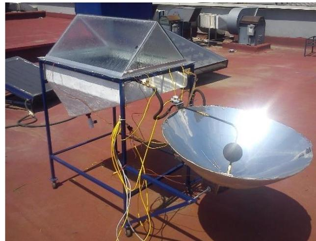
Prototipo de evaporador solar
